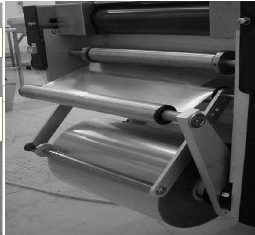
Fig A2.2 Dettaglio di entrata in plastica
